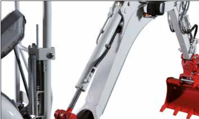
Hubzylinder auf der Rückseite des Hauptarms (Nackenzylinder) gewährt optimalen Schutz vor Beschädigungen.
