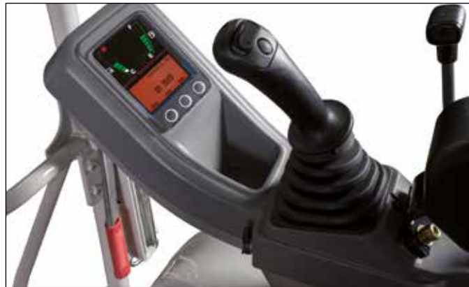
Übersichtliches Armaturenbrett mit hör- und lesbaren Warnungen; proportionale Ansteuerung des 2. Steuerkreises über den rechten Joystick.
