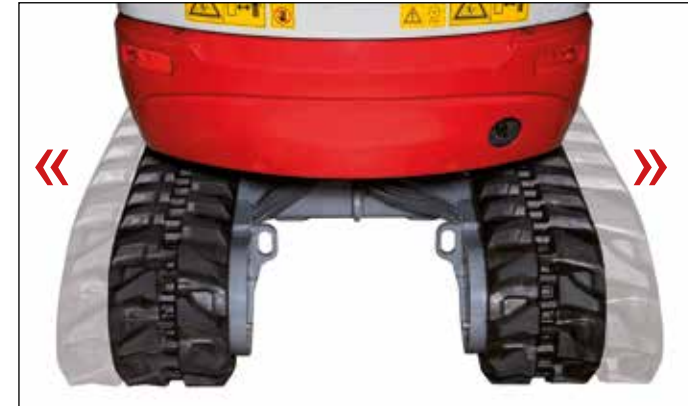
Raupenfahrwerk mit hydraulischer Spurverbreiterung.
