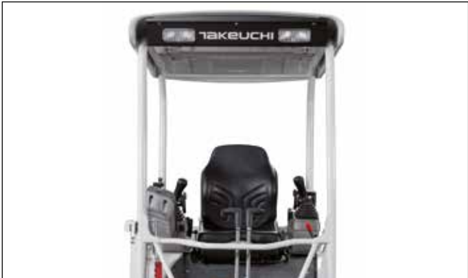
Fahrerschutzdach mit ROPS (ISO12117), TOPS (ISO12117-2), OPG (ISO10262 Stufe1) und Komfortsitz (wetterfeste Ausführung) mit Sicherheitsgurt.
